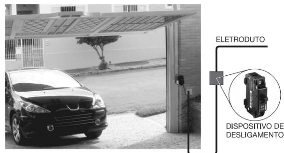
**Obs:** O dispositivo de desligamento total incorporado à fiação fixa deve garantir o desligamento de todos os condutores da rede elétrica, exceto o Terra.
