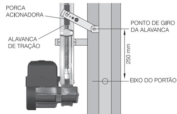
**9º Passo:** Com o portão fechado, mantenha uma inclinação de 50 mm na alavanca de tração, respeitando uma distancia do centro do ponto de giro da alavanca de tração e o centro do pino da porca acionadora.
