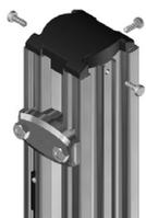
**6º Passo:** Posicione o automatizador verticalmente na coluna do portão e solde os suportes de fixação na coluna, respeitando as medidas da figura abaixo.
