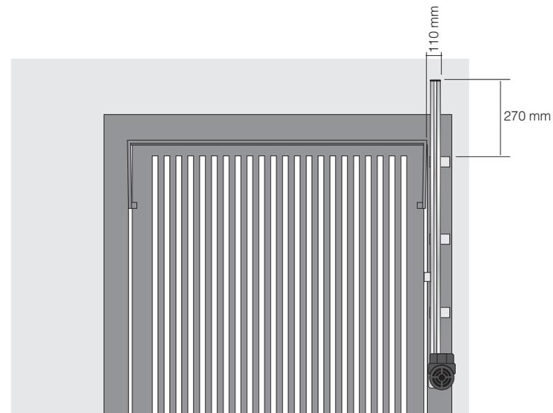
**7º Passo:** Encaixe a alavanca de tração no pino da porca acionadora do automatizador.
