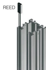
**2º Passo:** Coloque a borracha de proteção dos fios no alojamento do reed, percorrendo todo o perfil do trilho.
